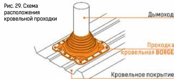
Рис. 29. Схема расположения кровельной проходки
