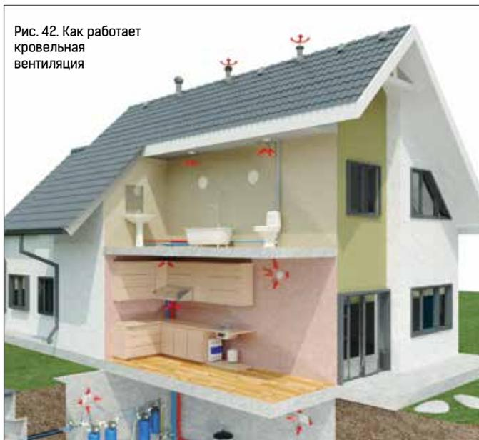
Рис. 42. Как работает кровельная вентиляция
